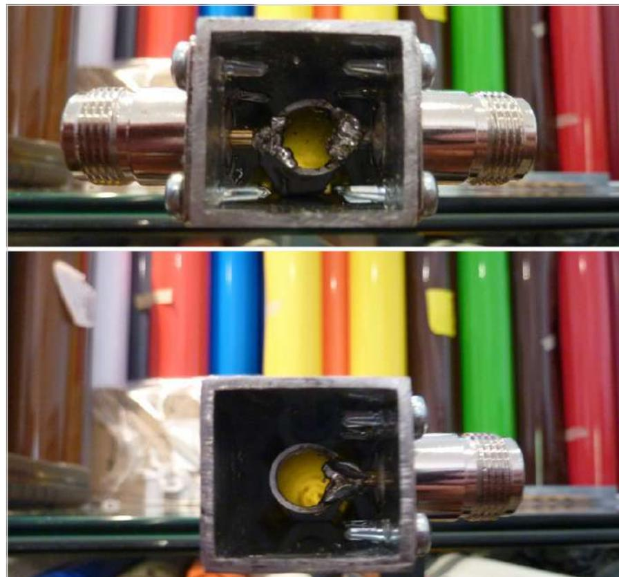
prenderei sezioni di tubi un po' più grandi. Lì ho fatto con quello che avevo a portata di mano. Ho appena ordinato prese N del telaio e N per i coassiali delle due antenne e l'alimentazione. Il sistema con le parti in plastica della lavatrice può anche essere rivisto per arrivare a centrare più correttamente il tubo da 12 mm al centro del tubo quadrato. Insomma, mi resta da fare i 2 tappi per chiudere le estremità di
